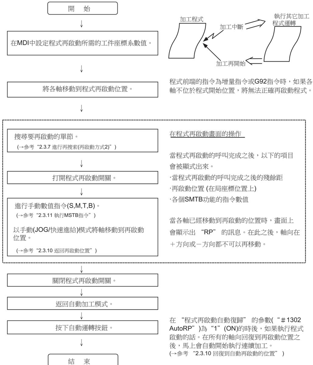
(註 1) 單節停止模式訊號關閉時，軸在返回再啟動位置後，直接開始加工，不會臨時停止。(在自動再啟動位置返回有效狀態下迴圈啟動時)
